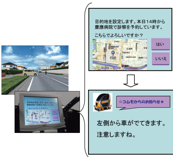
図5 模擬車載装置および提示される情報例
