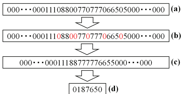
図 8 タッチセンサの情報処理
